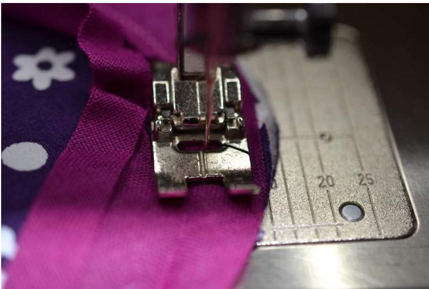
Das Band ringsherum in der Falz annähen. Ich nähe nicht genau auf der Falz, sondern ein ganz kleines Stückchen daneben, da sonst beim umklappen das Schrägband wegen der vielen Stofflagen zu kurz wird. Dazu stelle ich die Nadel einfach eine Position weiter nach rechts. So kann ich mich nach der Nähfußmarkierung richten, nähe aber trotzdem etwas daneben.
